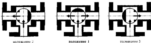
Режим работы крана с Т-образной пробкой
